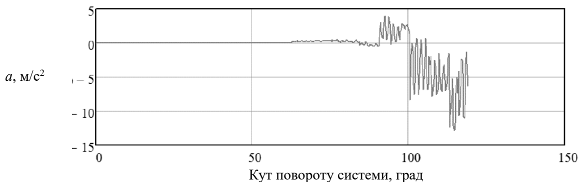
Рисунок 9 – Характер прискорень НВ при перекиданні
