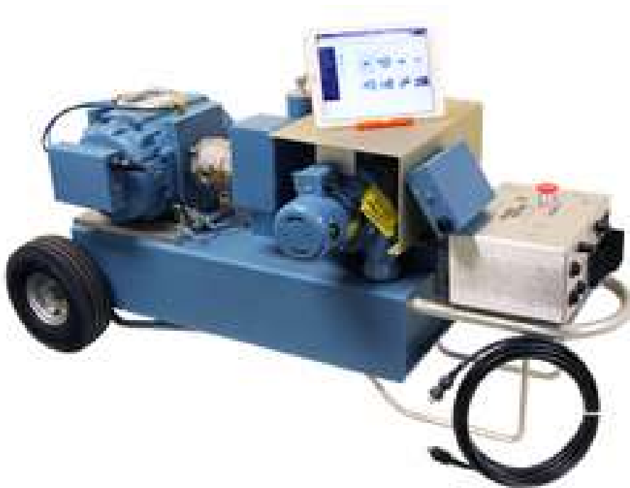
Рисунок 1 – Зовнішній вигляд повірочної установки Dresser моделі 6 лічильників газу
